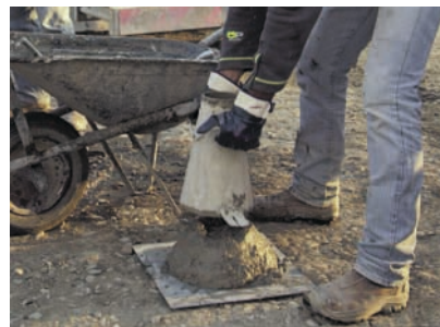
Prova di Slump
